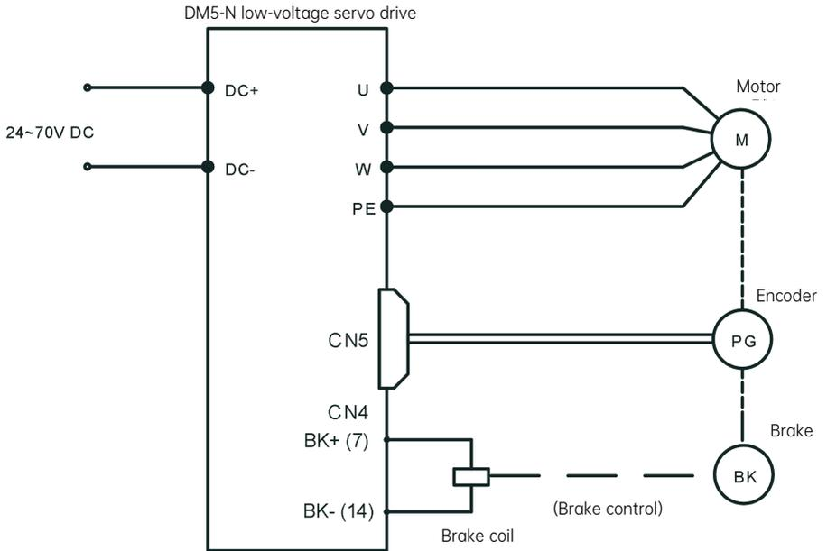
Fig. 5-3 Brake wiring diagram
