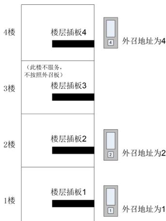
图 6-6 外召板安装及地址设定指导图
