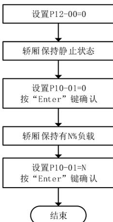
图 10-3 模拟量超满载自学习流程图
