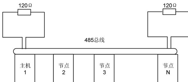
图 3-12 终端电阻接入方式示意图
