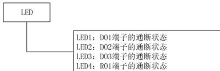
图7-4 开关量输出端子状态
