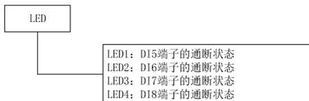
图7-3 开关量输入端子状态
